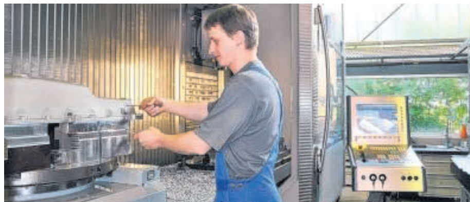
Thomas Zschornack spannt in die computergesteuerte Fräsmaschine ein Aluminium-Gussteil ein. Es wird für Dieselmotoren gebraucht. Foto: Olaf Barth
